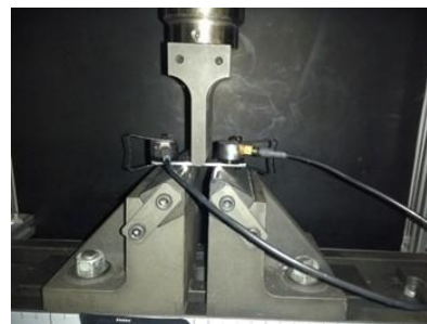
Figura 1. Ensayo de flexión (a) esquema de disposición, (b) ensayo.
