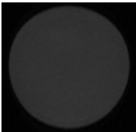
Figura 8. En la imagen se presenta el maniquí nuevamente irradiado para alcanzar una dosis de 300 Gy. Esta prueba se realizó para verificar la alteración de la respuesta una vez que la reparación del material tiene lugar y al mismo tiempo explorar la posibilidad de volver a usarlo como detector.
