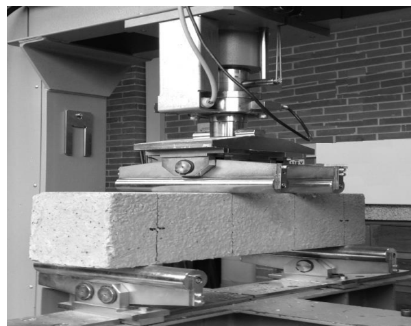
Figura 4. Configuración del ensayo de módulo de rotura.
