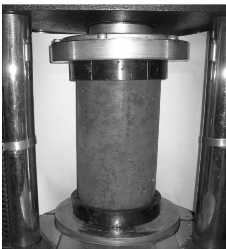
Figura 1. Configuración del ensayo de resistencia a compresión.
