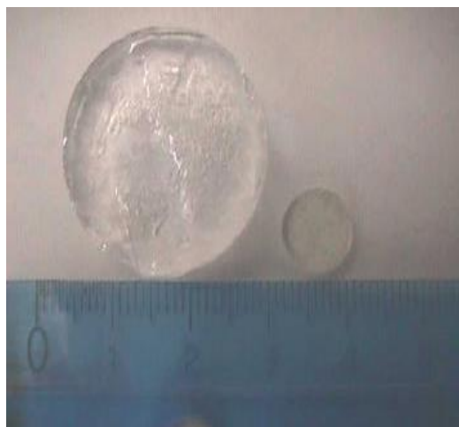
Figura 1. Hidrogeles de poli(acrilamida-co-ácido maleico): a) Hinchado b) xerogel [6].
