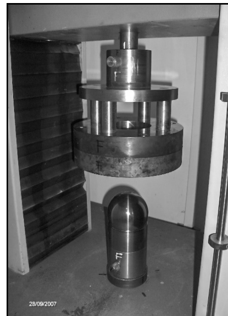
Figura 2. Equipo usado para determinar la curva límite de formabilidad.
