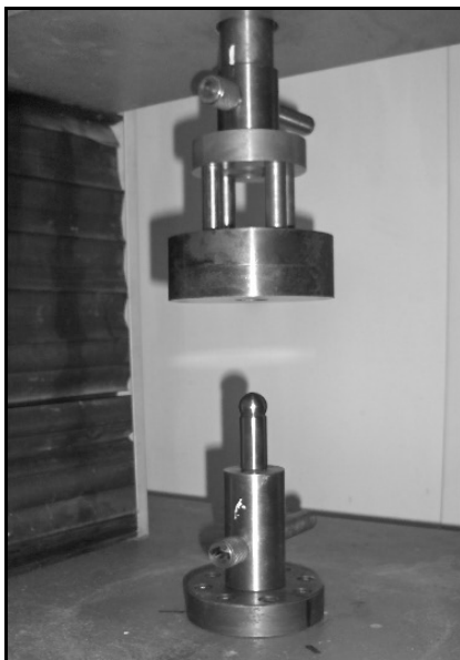
Figura 1. Detalles del diseño del equipo para el ensayo de altura de copa.
