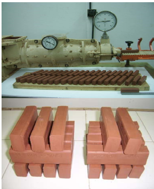
Figura 1. Probetas en verde extruidas de mezclas de LR y arcillas.
